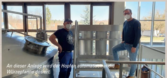
An dieser Anlage wird der Hopfen automatisch in die Würzefanne dosiert.
